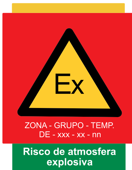
Figura 1 – Placa de sinalização de área classificada.
