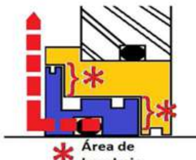
Figura 4: Protetor restritivo rotativo em “L” provoca o deslocamento do ar e o labirinto age como um “mini compressor”, provocando o ingresso de água e poeira para o interior do motor elétrico “Ex”.
