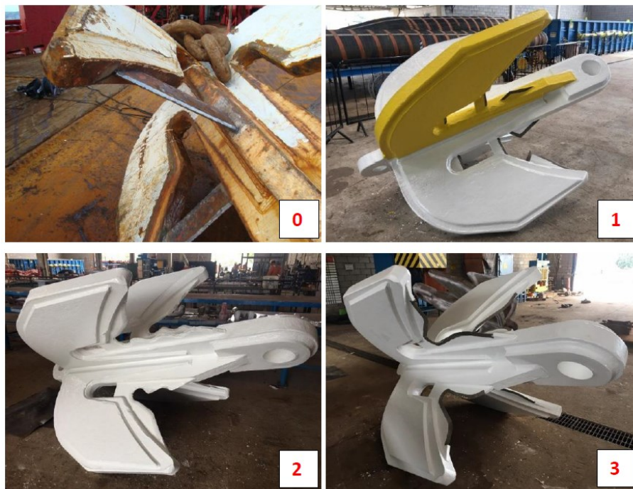
Figura 4. Garateias de corte confeccionadas para atendimento as emergências.
