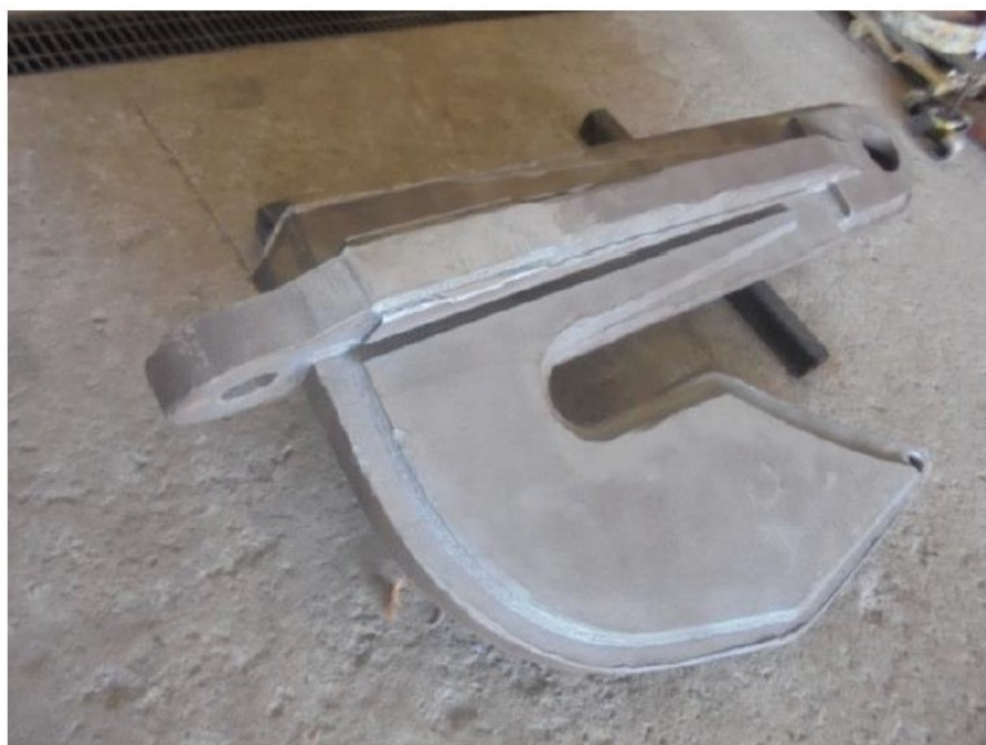
Figura 6. Garateia adaptada para içamento (garateia Pateta).
