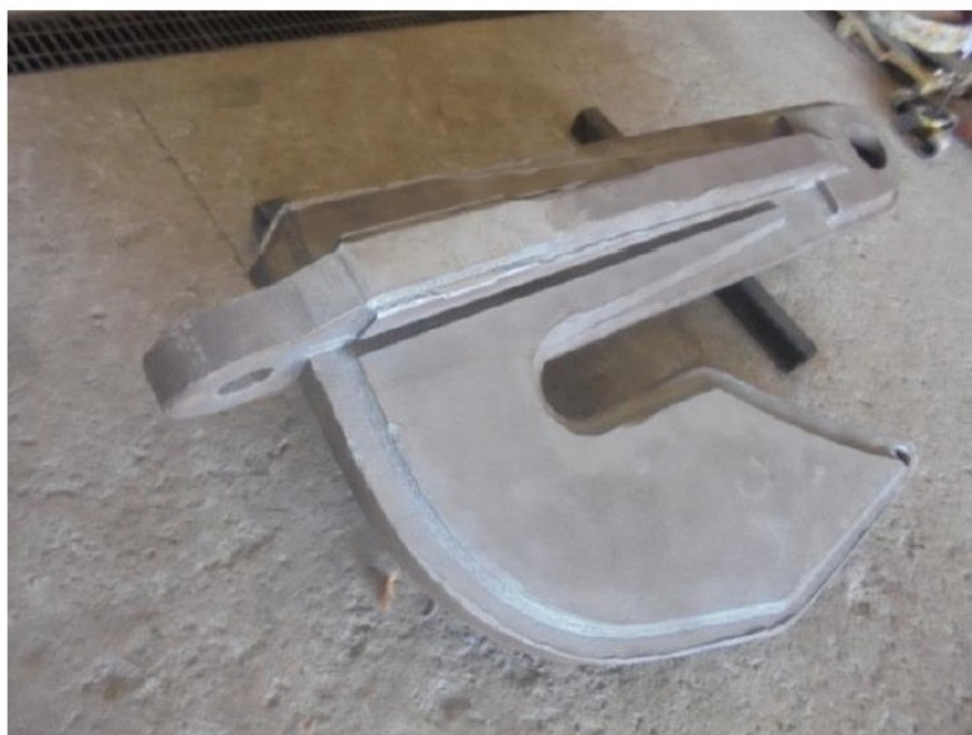
Figura 6. Garateia adaptada para içamento (garateia Pateta).
