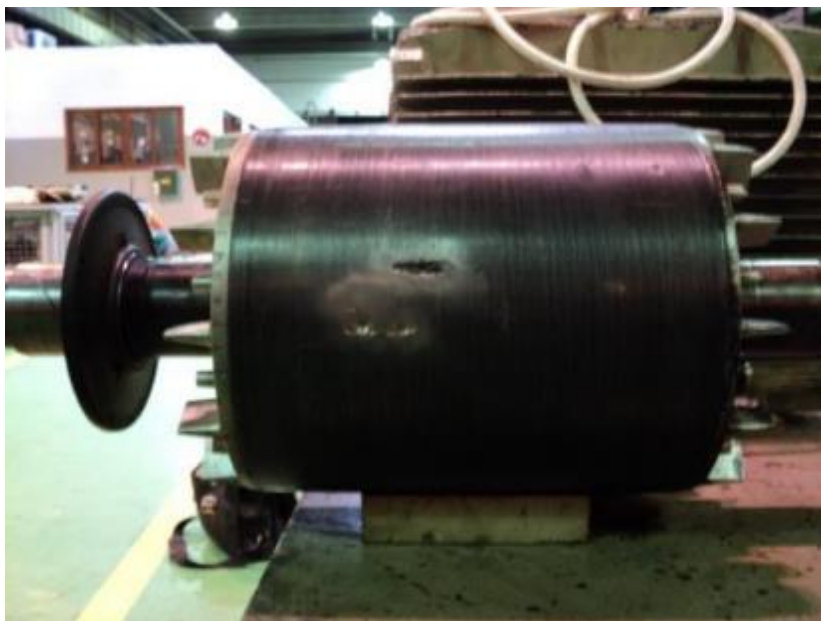
Figura 5 - Rotor do motor danificado devido à alta corrente de partida.
