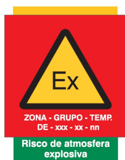
Figura 1 - Placa de sinalização de área classificada.
