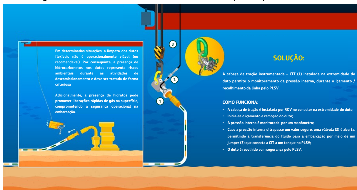
Figura 8 – Recolhimento de dutos flexíveis utilizando cabeça de tração instrumentada.
